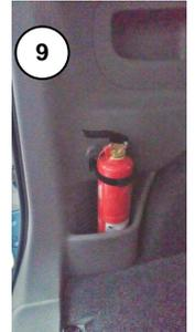
**EXTINTOR.** Todos los vehículos irán provistos de un extintor de incendios adecuado, homologado y en condiciones de uso.
